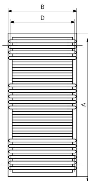
A – hauteur B – largeur C1-C5 – écartement des raccords D – écartement des consoles en horizontal E – écartement des consoles en vertical F – distance de l'axe de la console inférieure au bord inférieur du collecteur
