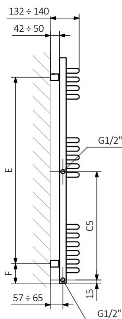
A – hauteur B – largeur C1-C5 – écartement des raccords D – écartement des consoles en horizontal E – écartement des consoles en vertical F – distance de l'axe de la console inférieure au bord inférieur du collecteur
