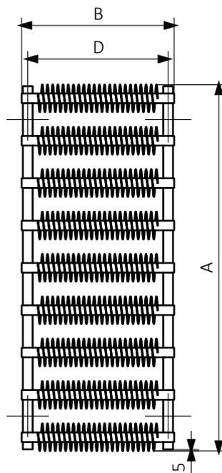
A – hauteur B – largeur C1-C5 – écartement des raccords D – écartement des consoles en horizontal E – écartement des consoles en vertical F – distance de l'axe de la console inférieure au bord inférieur du collecteur
